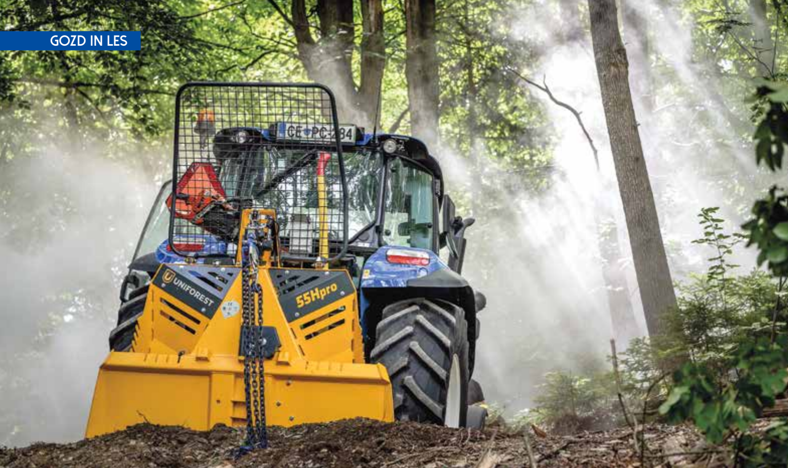
Hidravlični gozdarski vitel 55Hpro z vlečno silo 5,5 ton je najpogostejša izbira uporabnikov.
