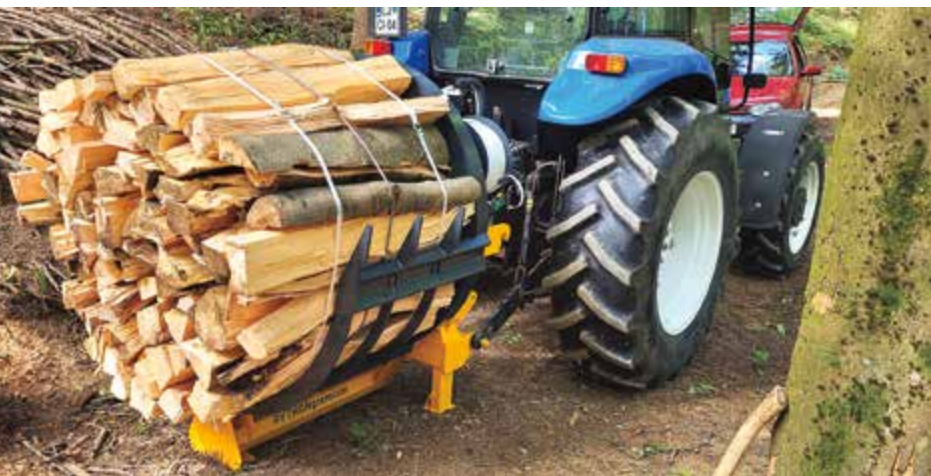
Prenovljen povezovalnik drv Python Premium omogoča enostavno povezovanje metrskih polen.
