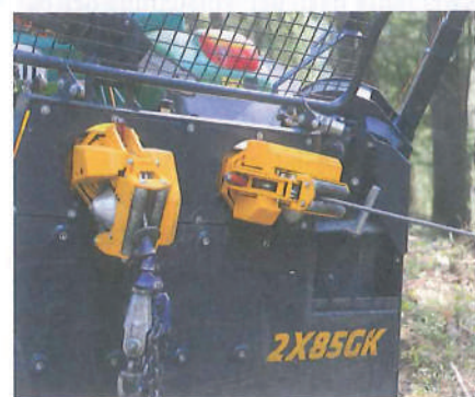
Doppeltrommel-Konstantzug-Seilwinde mit Proportionalbremse.
