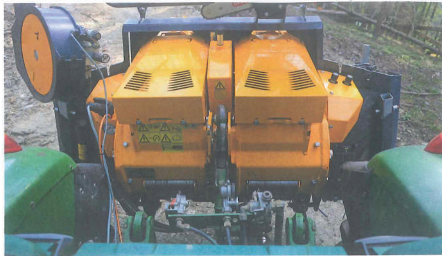
Die beiden Trommeln wickeln das Seil grundsätzlich sauber auf, trotzdem hätten sich unsere Testfahrer eine bessere Sicht auf die Seiltrommeln gewünscht.
