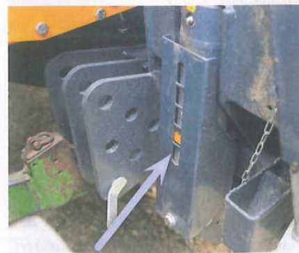
Praktikable Anzeige für die Stellung des schwenkbaren Rückeschildes (siehe Pfeil).
